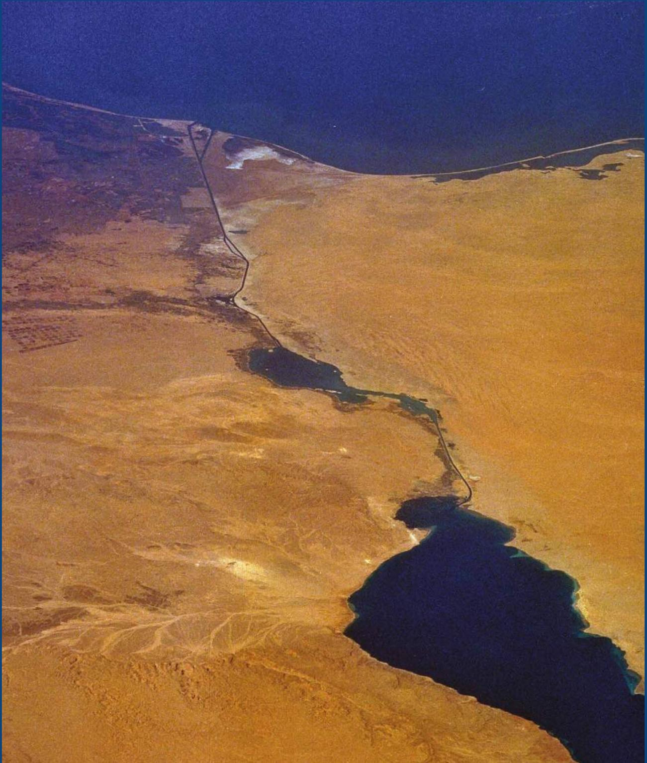
Vue satellite du Canal de Suez. Sa largeur navigable sous 11 m de tirant d'eau est de 190 m (initialement 44 m). Le Canal entre Port-Saïd et Suez a une longueur de 162 km. Les chenaux d'accès au nord et au sud portent la longueur totale de l'ouvrage à 195 km. » © NASA Johnson
